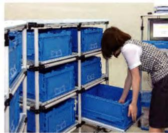
作业人员输入商品数据后，分拣目标的箱柜（可动式柜板）将自动弹出。将商品装入该箱柜（箱子），并把箱柜切实推入后，即完成分拣。这样简单的结构，可以避免发生人为失误。
