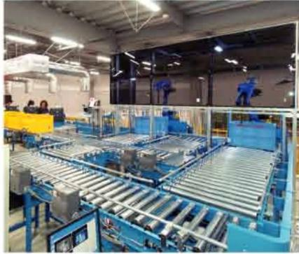
机器人自动投入系统 (投入区域自动供应输送机)
