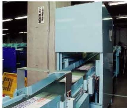
条形码读取器自动输入系统 (上面读取)
