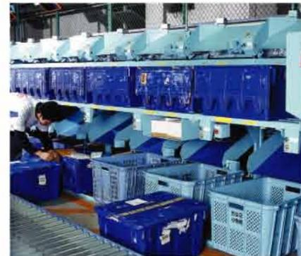
因翻转滑道作用的单侧上下滑道规格 (上下滑道部)
