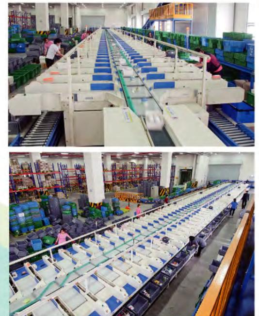
〈滑块式〉零散物品分拣机 **自动分拣机 mini ASHS** (圆筒形对应类型)
