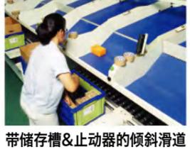
带储存槽&止动器的倾斜滑道 (选件)
