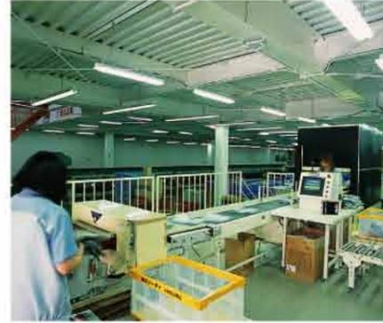
自动检针机&图像扫描自动输入系统
