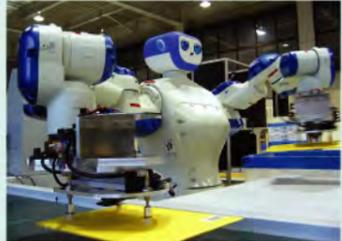
7轴双臂机器人 (株式会社安川电机制造)
