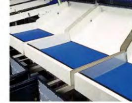
带储存槽的倾斜滑道 (选件)
