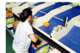
溜まり&ストッパー付スローブシュート (オプション) ※パッチの切り替え作業をスピーディかつ確実にを行う場合に威力を発揮します。
