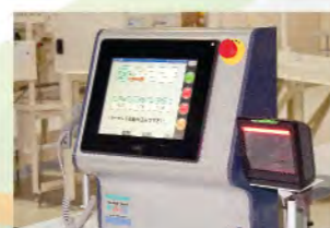
新型スリム操作盤 (投入パソコン)
