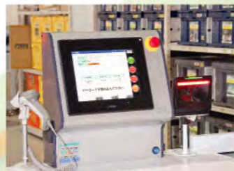
新型スリム操作盤(投入パソコン)
