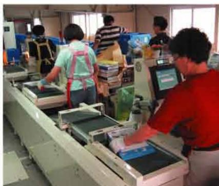
2段式自動投入コンベヤシステム
