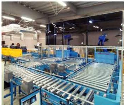
ロボット自動投入システム(投入エリア自動供給コンベヤ)
