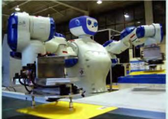
7軸双腕ロボット (株式会社安川電機製)
