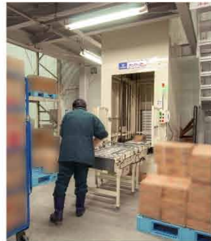
[多階式]パーチレーター/低温物流センター(-25℃)
