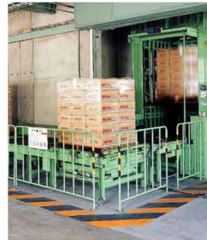
パーチレーター大型 / 物流センター
