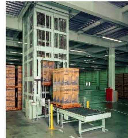
パーチレーター大型/物流センター
