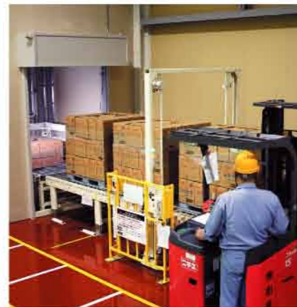
パーチレーター大型/食品物流センター
