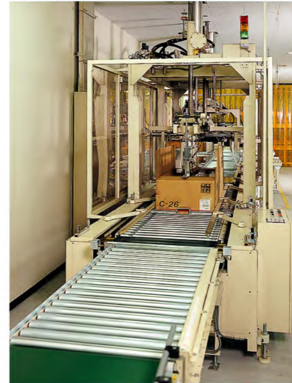
上フラップ折機/楽器生産工場
