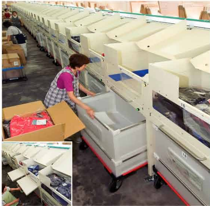
溜まり部落とし込み機能付スロープシュート&カート式シュート下受けボックス仕様
