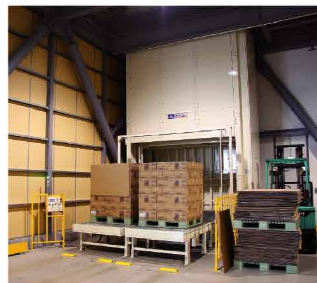
オートレーター大型(2列オートアシスター仕様)/物流センター
