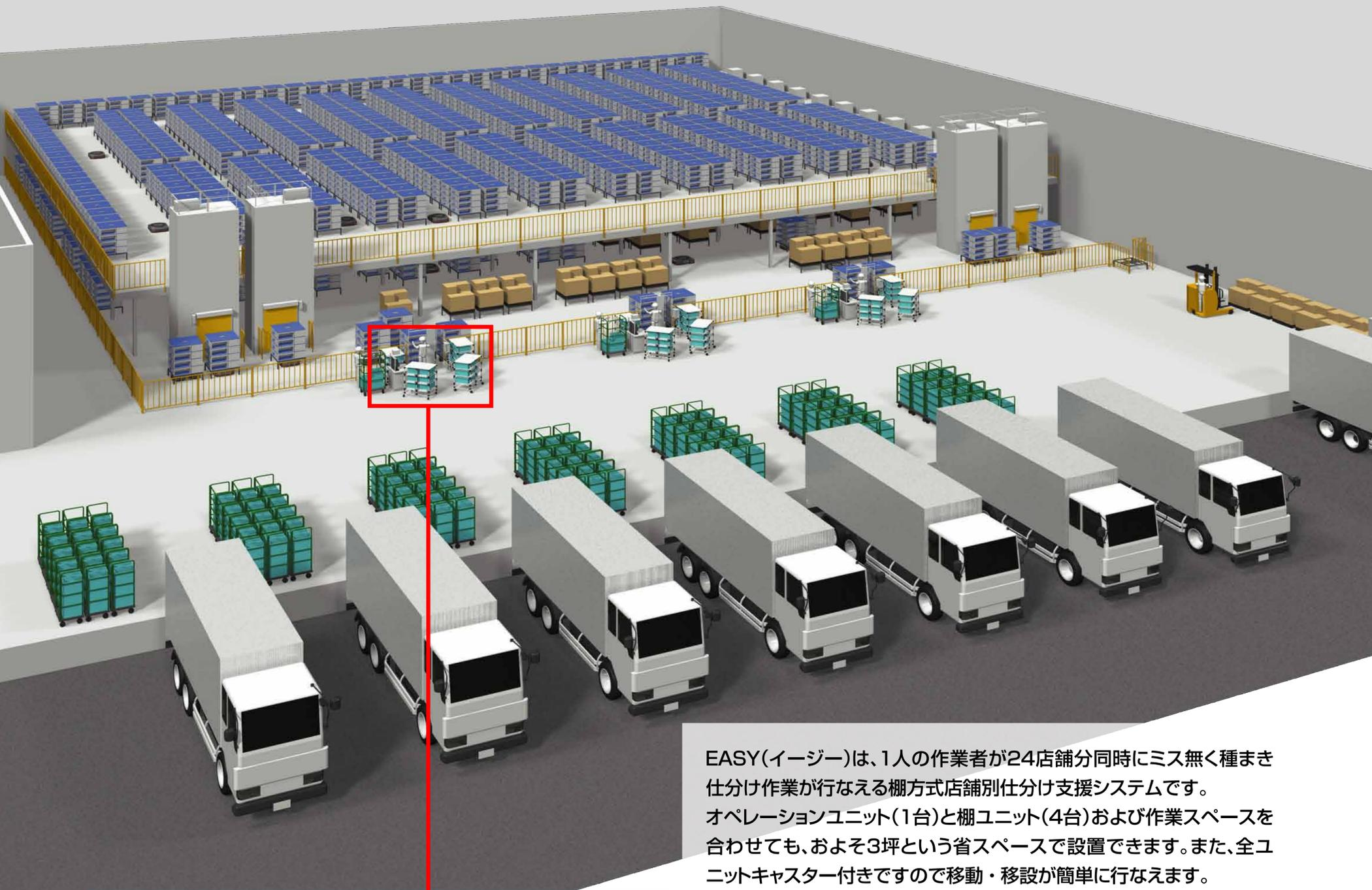
EASY(イージー)は、1人の作業者が24店舗分同時にミス無く種まき仕分け作業が行なえる棚方式店舗別仕分け支援システムです。オペレーションユニット(1台)と棚ユニット(4台)および作業スペースを合わせても、およそ3坪という省スペースで設置できます。また、全ユニットキャスター付きですので移動・移設が簡単に行なえます。商品コードを読み取ると、仕分け先の棚が自動的に出てきます。そこに商品を入れ、棚を戻すと実績が上がり作業完了となります。歩きまわる必要がなく熟練度に左右されないため、誰でもミス無くすぐに高い生産性を得ることができます。(1時間当たりの棚開閉回数700~900回)
