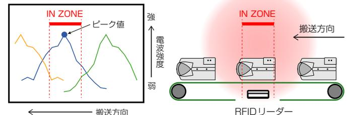
商品(RFタグ)がRFIDリーダーに近づくにつれて受信電波強度(RSSI)が強くなり、遠ざかると弱くなる性質を利用し、検出した波形が山型になっているか、さらに山型の頂点(ピーク値)がIN ZONE内にあるかを評価基準として、商品に正常なタグが付いているかを識別します。
