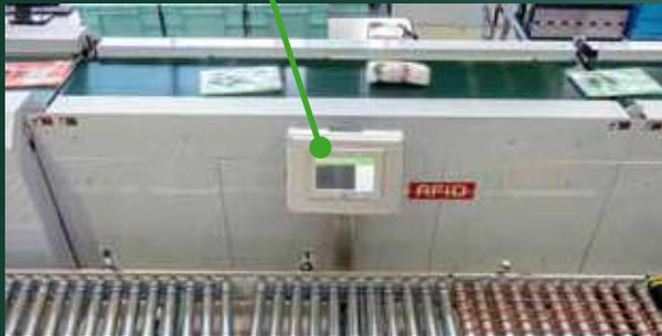
〈CP方式〉RFID自動入力システムは、\*PAS(バラ物自動仕分けシステム)を使用してRFタグ付き商品(アパレル品等)の店舗別仕分けを行なう際、RFタグの読み取り・入力作業を高速・高精度で自動化するシステムです。システム機器は、[RFIDリーダー内蔵コンベヤ装置]および[表示機能付RFIDリーダーコントローラ]で構成されており、商品 را載せる投入コンベヤとピースソーターの間に設置し、商品を高速搬送(70m/分)しながらRFタグを自動読み取り・入力します。また、読み取り状況をモニタ表示によりリアルタイムで確認することができます。
