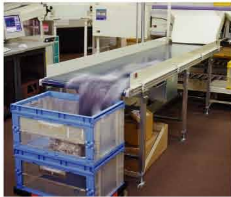
리젝트 물품 투입 에리어 반송 컨베이어
