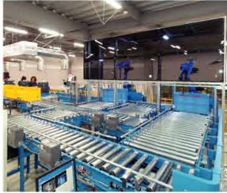
로봇 자동 투입 시스템(투입 에리어 자동 공급 컨베이어)
