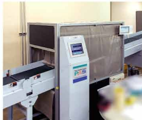
RFID 리더 자동 입력 시스템
