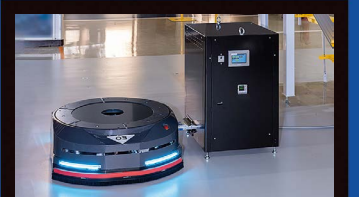
④ 自動充電システム
