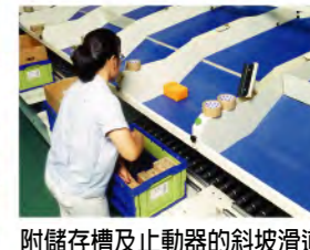
附儲存槽及止動器的斜坡滑道 (選項)
