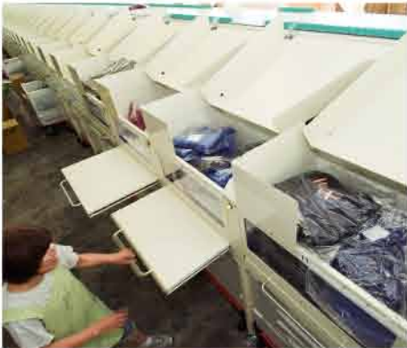
附落下功能儲池&滑道下方台車式儲物箱②
