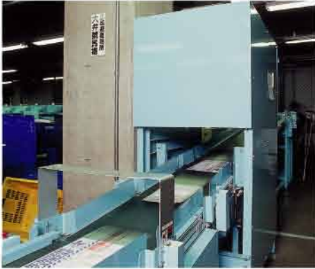
條碼讀取器自動輸入系統（上面讀取）
