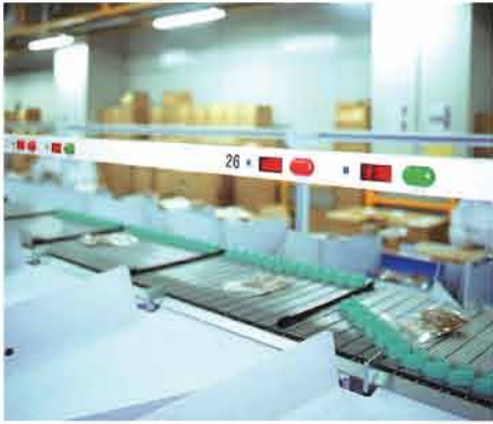
滑道端數位顯示器（店鋪No、剩餘數、結束顯示）
