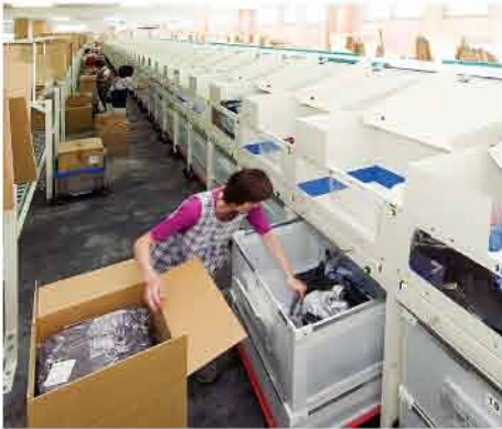
附落下功能儲池&滑道下方台車式儲物箱①
