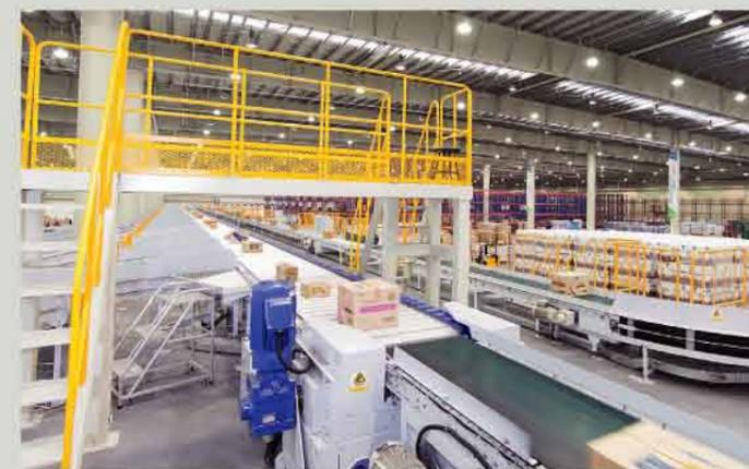
(滑塊式)零散物品分選機
