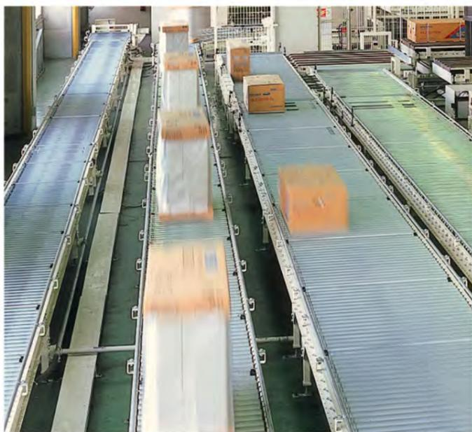
生產線/堆積式專用驅動滾輪輸送機
