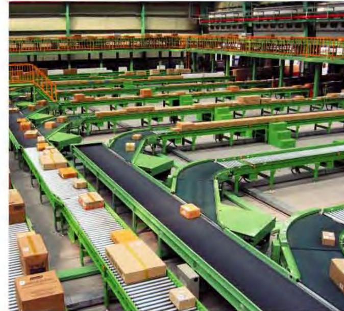
物流集散站/堆積式專用驅動滾筒輸送機&皮帶輸送機
