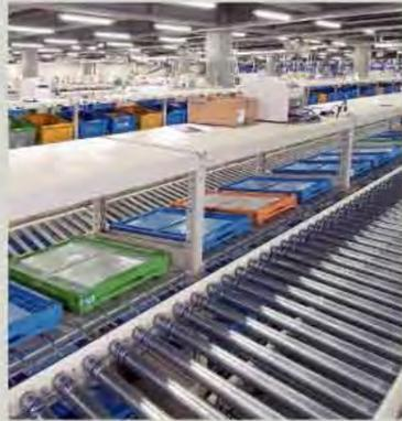
多楔帶式驅動機動滾筒輸送機
