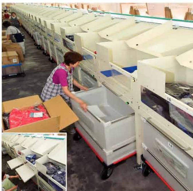
附滑槽積存功能滑道及滑道下台車式儲物箱規格
