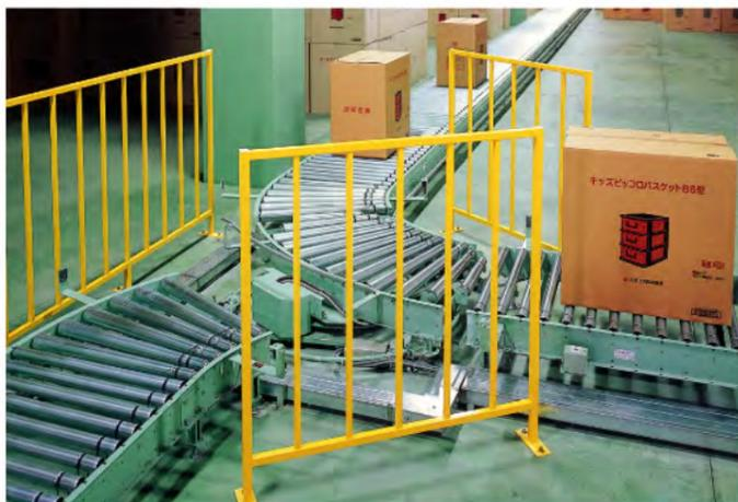
生產線/環型驅動滾輪輸送機 &amp; 方向轉換組件
