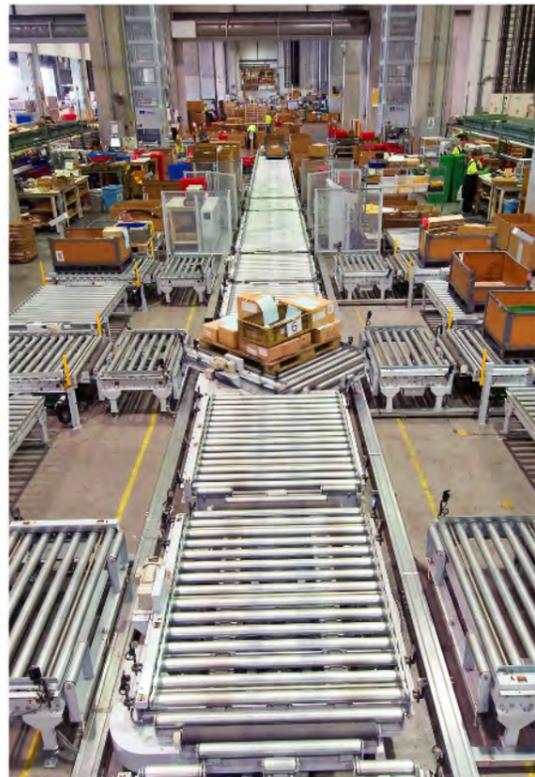
物流中心/鏈條驅動滾輪輸送機 &amp; 方向轉換組件
