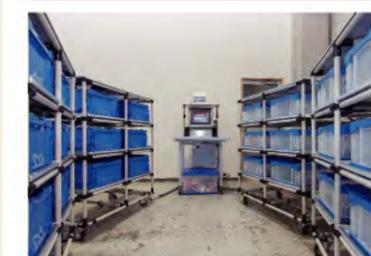
各單元都裝有腳輪(含煞車), 除了能更容易移動、改變設置地點以外, 還能夠配合作業人員的位置自由做產線佈局。另外, 若分揀店鋪數增加, 也可以增設站點搭配。(最多可有8站=192店鋪)
