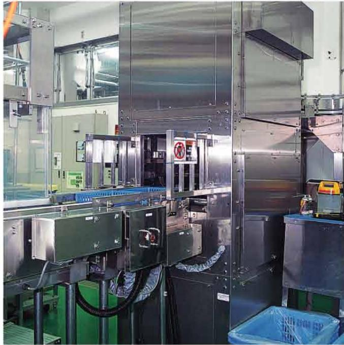
Vertikator小型輕量型 (不鏽鋼規格/冷凍食品生產工場)
