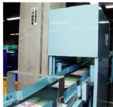
側面讀取條碼讀取器及圖像掃描自動輸入系統
