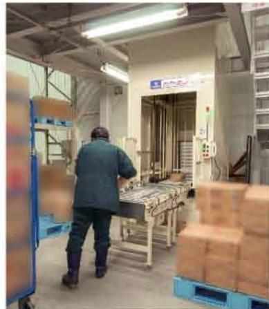
[多層式] Vertikator/低溫物流中心 (-25°C)
