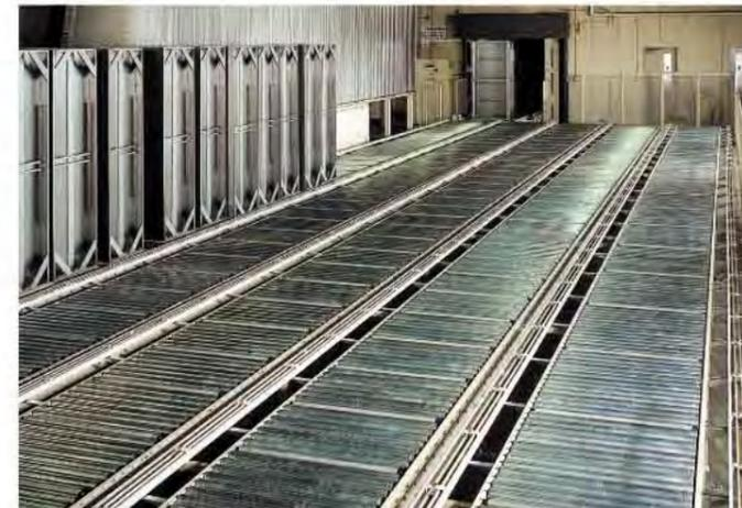
生產線/堆積式專用驅動滾筒輸送機
