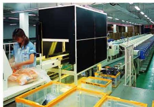
圖像掃描自動輸入系統及殘次品返送輸送機
